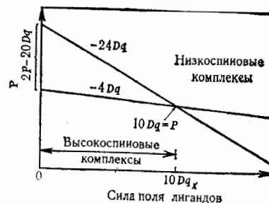
Рис. 10.13. Зависимость энергии спаривания ( 2P ) для октаэдрических d^6 -комплексов от силы поля лигандов
